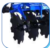
USADO PARA PICAR ELIMINAR LAS MALEZAS NO DESEADAS O RESIDUOS DE CULTIVOS
