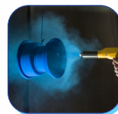
PINTURA RECUBIERTA EN POLVO ASEGURA UN ÓXIDO MÍNIMO SOBRE LA IMPLEMENTACIÓN
