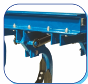
MUELLE HELICOIDAL AMORTIGUADOR ASEGURA UN MOVIMIENTO IDEAL DEL DIENTE PARA SUPERAR EL OBSTÁCULO Y MINIMIZAR LOS DAÑOS
