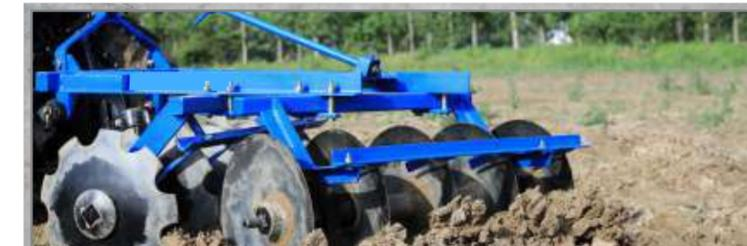
Útil para campo abierto para arado superficial para desgranado. de terrones, preparación de semillero, enterramiento de materia orgánica Sustancia y restos de corte de cosecha
