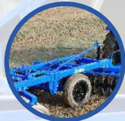
**ELEVADO HIDRÁULICAMENTE NEUMÁTICO CENTRAL PARA FACILITAR LA INSTALACIÓN TRANSPORTE**
