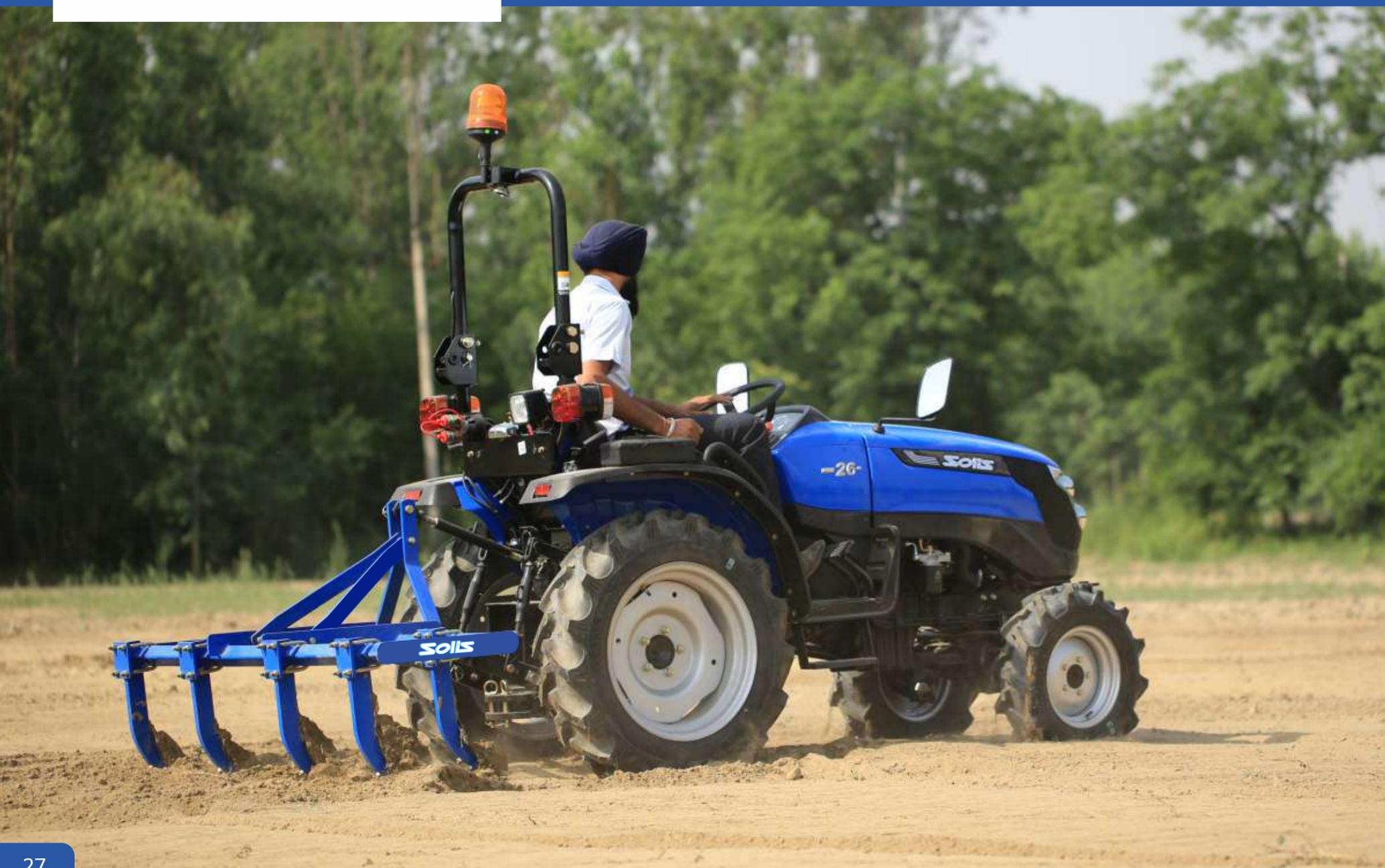
El subsolador es un implemento agrícola desarrollado para la labranza profunda, algo que está más allá del alcance de otros implementos primarios. El subsolador Solis es una máquina rentable con palas de acero de alta resistencia y funciona de manera eficaz en condiciones difíciles. La rotura de capas duras en profundidad en el suelo garantiza una disponibilidad óptima de humedad para el cultivo y, por lo tanto, aumenta su productividad general.
