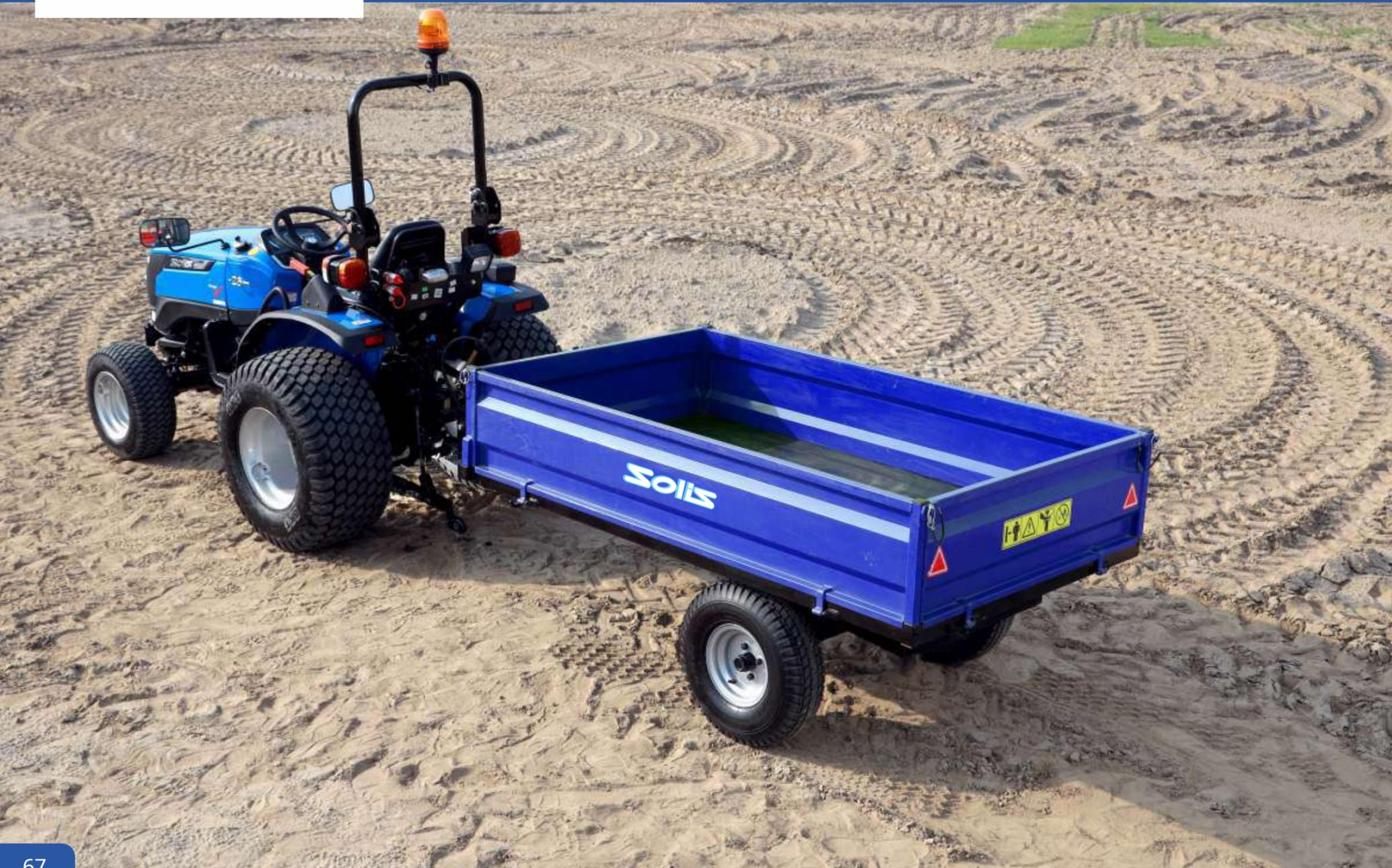
Los remolques Solis tienen un diseño resistente que soporta incluso las demandas de carga y transporte más exigentes en todas las condiciones. La descarga hidráulica y los paneles laterales plegables ayudan a descargar el material sin esfuerzo.
