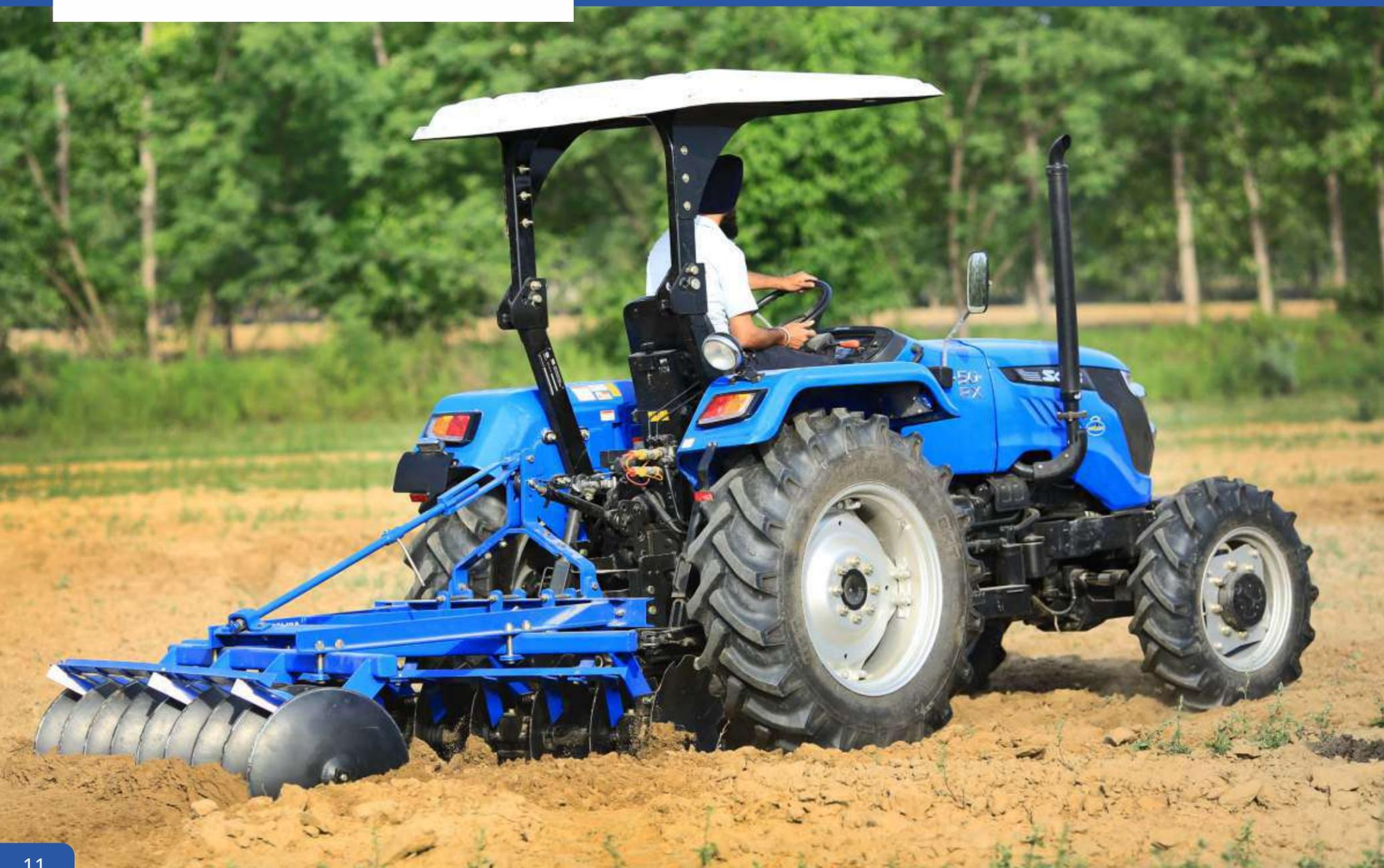
La grada de discos se utiliza para cortar las malas hierbas no deseadas o los restos de la cosecha. Los discos están desplazados y esta disposición garantiza que los discos corten repetidamente cualquier terreno para optimizar el resultado. La concavidad de los discos, así como su ángulo de desplazamiento, ayudan a aflojar y levantar el suelo de mejor manera.
