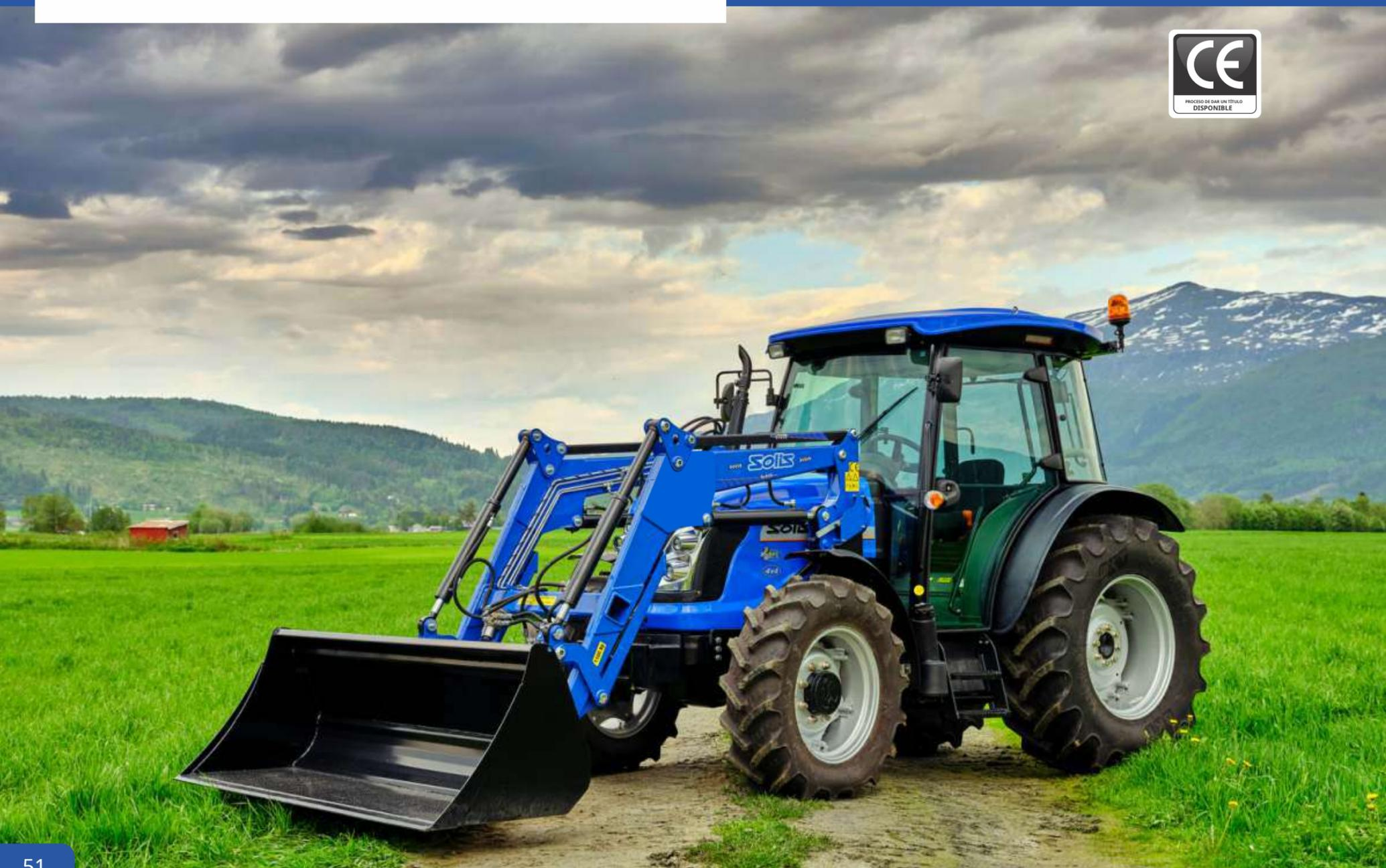
Un cargador es un tipo de accesorio de tractor que tiene un cucharón ancho montado en la parte delantera conectado al extremo de dos brazos para recoger material suelto del suelo, como tierra, arena o grava, y moverlo de un lugar a otro sin empujar el material por el suelo.
