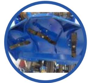
3 CUCHILLAS EQUIDISTANTES CON ALTA VELOCIDAD DE PUNTA PARA UN CORTE UNIFORME
