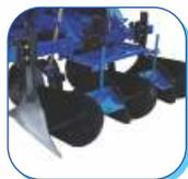
**ABRIDOR DE SURCOS CON REEMPLAZABLE PUNTO DE DESGASTE Y PROFUNDIDAD PINCHO AJUSTABLE**
